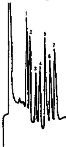
图1 七种一硝基苯类化合物气相色谱图 1—硝基苯; 2—o—硝基甲苯; 3—m—硝基甲苯; 4—p—硝基甲苯; 5—m—硝基氯苯 6—p—硝基氯苯; 7—o—硝基氯苯
